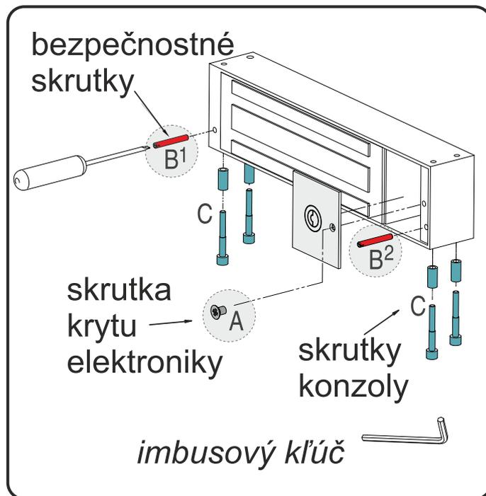
2. Uvoľnite a vytiahnite bezpečnostné skrutky B1 a B2. Použite tenký plochý skrutkovač.
