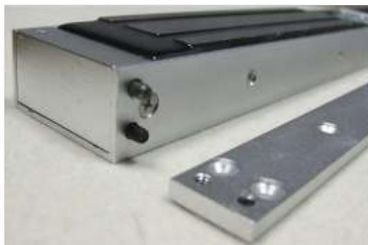
Takto uvoľnenú konzolu je možné inštalovať pomocou montážnych skrutiek na zvolené miesto - pevný rám dverí. Materiál, na ktorý je konzola pripevnená musí byť dostatočne pevný, aby vydržal váhu tela magnetu, ktorý bude ku konzole pripevnený a zároveň zabezpečovaciu silu magnetu, t.j. silu tlaku alebo ťahu, ktorý môže byť vyvíjaný na zabezpečené dvere (záмок je v aktívnom stave - je k nemu privádzaný prúd).
