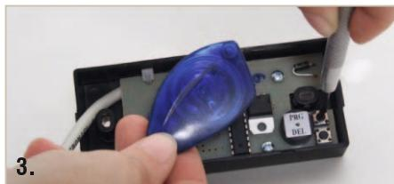
Priložením identifikátora do čítacieho poľa zaznie **jedno krátke a následne jedno dlhé pípnutie**. Obe pípnutia sú sprevádzané trvalým rozsvietením zelenej LED. Identifikátor je naprogramovaný. Priložte ďalší identifikátor.
