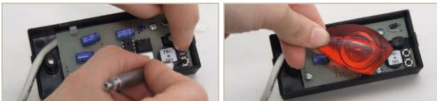
Pre nastavenie MASTER kľúča stlačte tlačidlo PRG, keď budete počuť **rýchlo prerušovaný tón** uvoľnite tlačidlo PRG a stlačte tlačidlo DEL. Hned ako sa ozve **prerušovaný tón - pípanie** tlačidlo DEL uvoľnite a počas trvania prerušovaného tónu priložte do čítacieho poľa OPJ RAK BES SLIM identifikátor, ktorý chcete používať ako MASTER.
